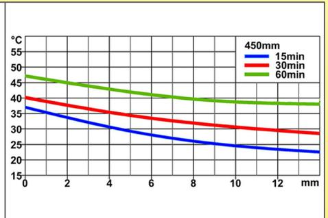
在不同的加热次数后，热渗透到样品里，在样品和加热器之间450mm的距离。
