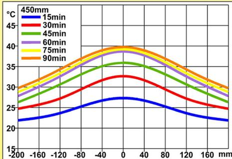
从中间到边缘的温度，在不同的次数后，在样品和加热器之间450mm的距离。
