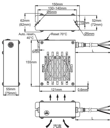
**9PF3型号:** 自控，配备一个可调节的控制温控器，其探头被直接安装在气流中，带一个印刷°C和°F的刻度盘，以及一个固定设置手动复位限温器。在这型号中，可以选择两种操作模式：连续通风模式，其中风扇连续操作，而温控器打开和关闭加热器是根据温度设定而定的；以及一个自动模式，其通风和加热是同时被温控器所控制。
